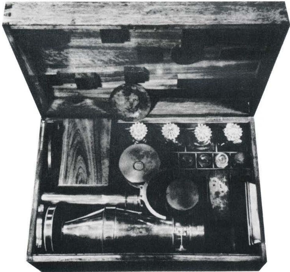
Helmetal-kameraet blev leveret i trækasse med stativ kassetter, plader, joderingsapparat og fremkaldereapparat samt kemi. Pris 120 gilden i 1841. Deutsches Museum, München.
