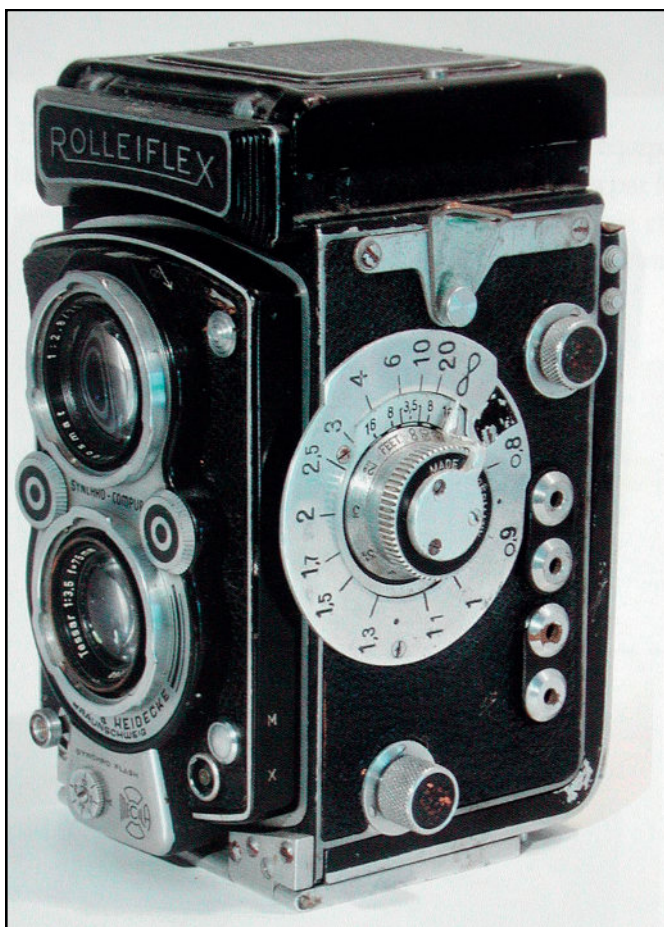
Rolleiflex med stor afstandsskala og modificeret synkronisering.
