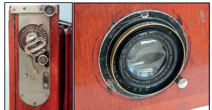
Deckrullo-Nettel, før 1919. Betjeningsiden på Deckrullo-Nettel. C.P. Goerz Doppelanastigmat Celor F=180mm 1:4,8
