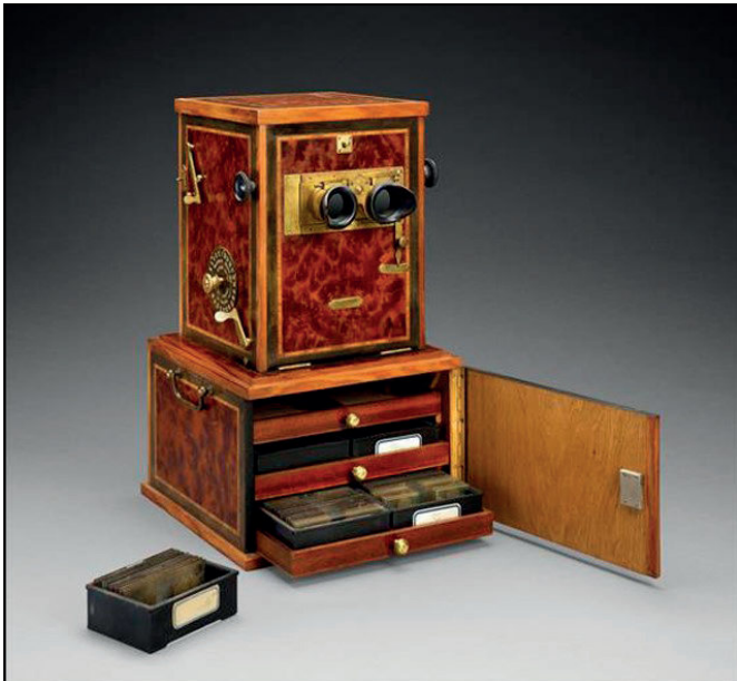
Betragteren taxiphote. De to okularer kunne justeres indbyrdes med en millimeterskrue og hele fronten kunne vippes fremover.
