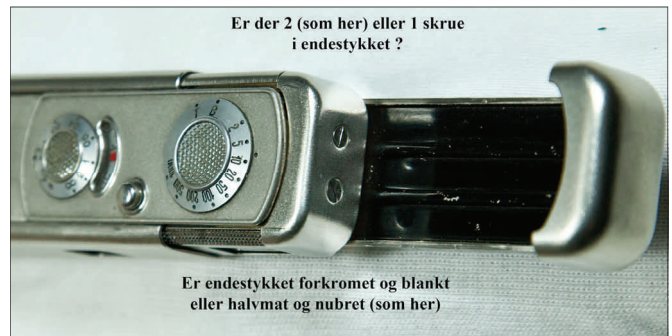
1. skrue starter omkring '12276' Halvmat og nubret ses fra '11241' - men der findes også forkromede endestykker på senere kameraer
